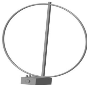
Рис. 5. Модель антенны, разработанная в программе Компас 3D
